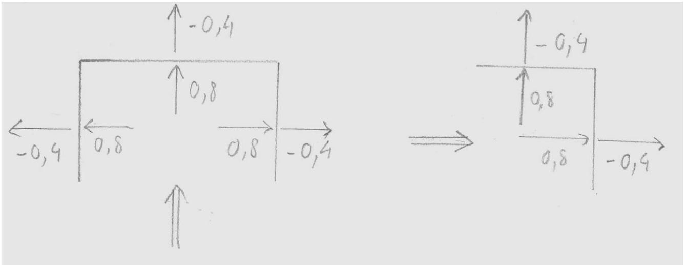
Coefficients de force sur les faces avec un vent à 90° en service:
