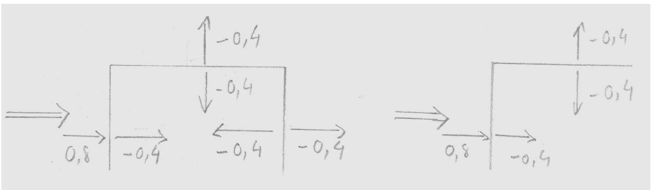
Coefficients de force sur les faces avec un vent à 180° en service:
